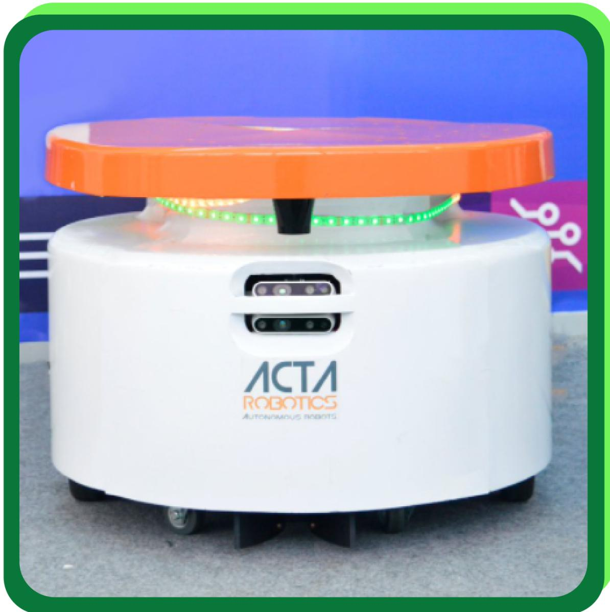
O Kappabot, primeiro robô móvel autônomo (AMR) a ser fabricado no Brasil, ajuda a melhorar a eficiência de processos com deslocamento horizontal, sejam estes de transporte de materiais, higienização de ambientes ou monitoramento de ambientes.
