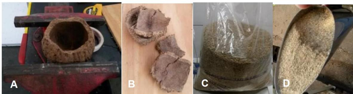
Figura 4. Etapas de moagem do mesocarpo da castanha: A) Quebra do mesocarpo na morsa. B) Pedacos quebrados do mesocarpo para moagem no moinho de facas. C) Partículas menores que 4 mesh após moagem no moinho de facas. D) Partículas menores que 18 mesh após moagem no moinho de martelos. Fonte: (Petrechen, 2017).
